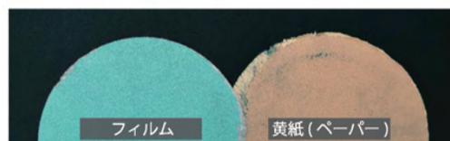
[写真2] 基材耐久テスト比較写真
