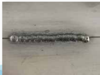
ATCによる0.6mm(ギャップあり)突合せ溶接
