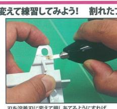
刃を溶着刃に変えて押してあてるようにすれば簡単に溶着。
