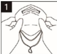
図のようにノーズピースが前にくるようにゴムバンドが下に垂れるように持ちます。
