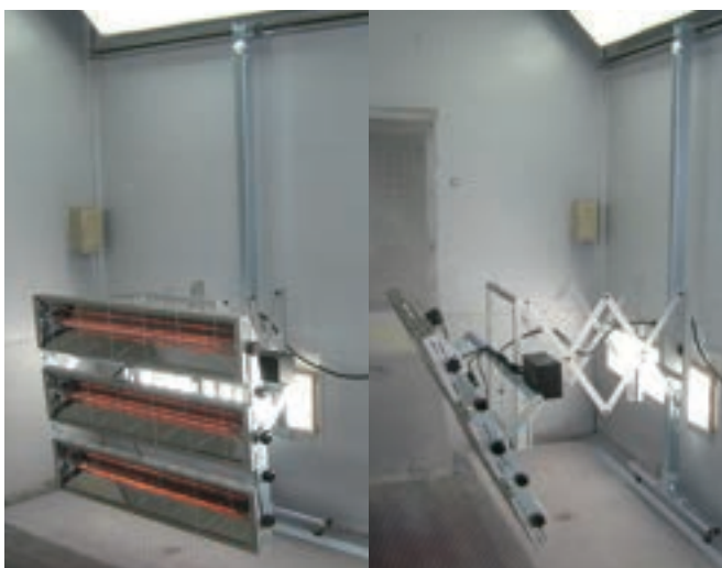
▲ブース壁面レール式乾燥機（伸縮式）
