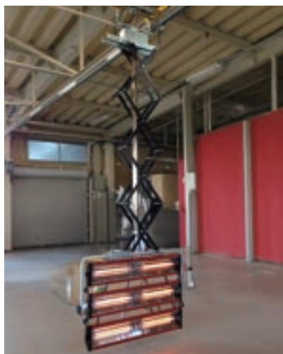
▲天吊りカーボン式 赤外線乾燥機
